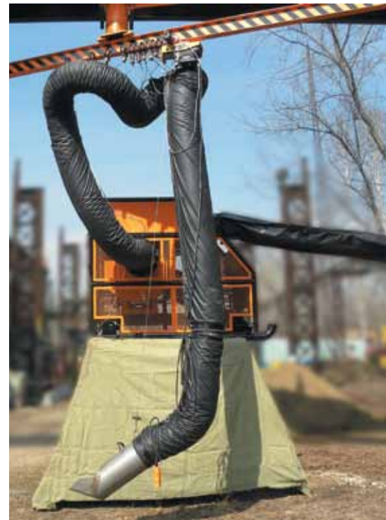
Пневмоснегуборочная установка («Снегопылесос»)
