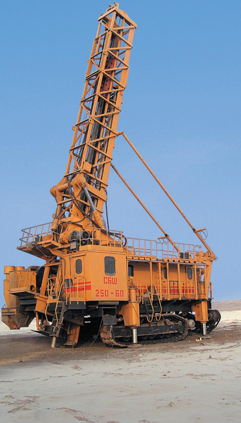
В 2010 г. станок СБШ-250/270-60КР был введен в эксплуатацию на предприятии, производящем буровые работы на угольных разрезах Сибири. Производительность буровых работ сегодня составляет 320-330 м/п в смену.
