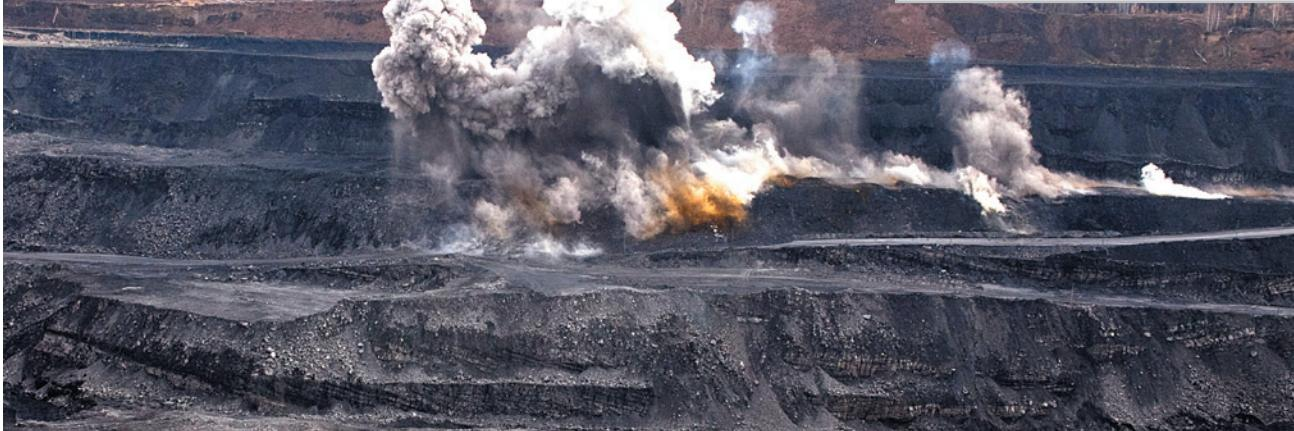
исключают возможность наложения взрывания двух и более скважин, — поясняет Александр Григорьевич. — В свою очередь точность срабатывания повышает качество взрывных работ. Вся сила и энергия взрыва направлены как бы внутрь, на дробление горной массы».
