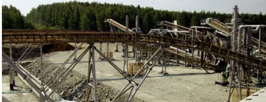
Один из крупных проектов ЗАО «ПМЗ» в 2011 году — ООО «Инвест-Проект». На это предприятие поставлен 21 модульный конвейер с шириной ленты от 650 мм до 1200 мм
