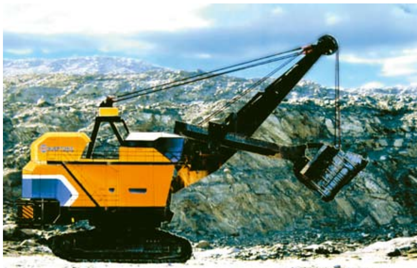
Рис. 4. Карьерный экскаватор ЭКГ-50 (проект)
